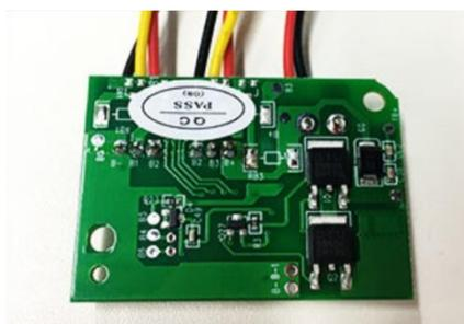
Das Temperaturkontrollsystem verhindert die häufigste Fehlerursache bei akku-betriebener Elektronik: eine zu hohe Temperatur des Akkumulators. Dieses System überwacht die Temperatur des Akkumulators und unterbricht den Ladezyklus, um Schäden zu vermeiden. Sobald die Temperatur wieder entsprechend fällt, wird der Ladevorgang des Akkus wieder aufgenommen.
